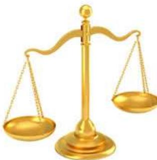
Vaga (njem. *die Waage*), kantar (rum. *cântar*) ili terazije (tur. *terazi*) je mjerni instrument za mjerjenje mase. Vage s oprugom mijere masu prema dužini istezanja opruge pod teretom. Balansne vase mijere masu uspoređujući moment sile poluge, na čijem je jednom kraju uzorak referentne mase, a na drugome mjerena količina.
